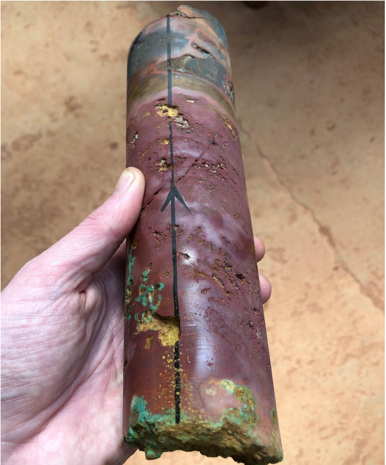
図3: ほぼすべてが赤銅鉱(赤銅鉱、 \text{Cu}_2\text{O} は重量の88.82%が銅)であることを示す坑井DD1571からの深度211.8メートルのコア。Niton測定値に基づくと、以下のサンプルの平均品位は37.7%銅です。
