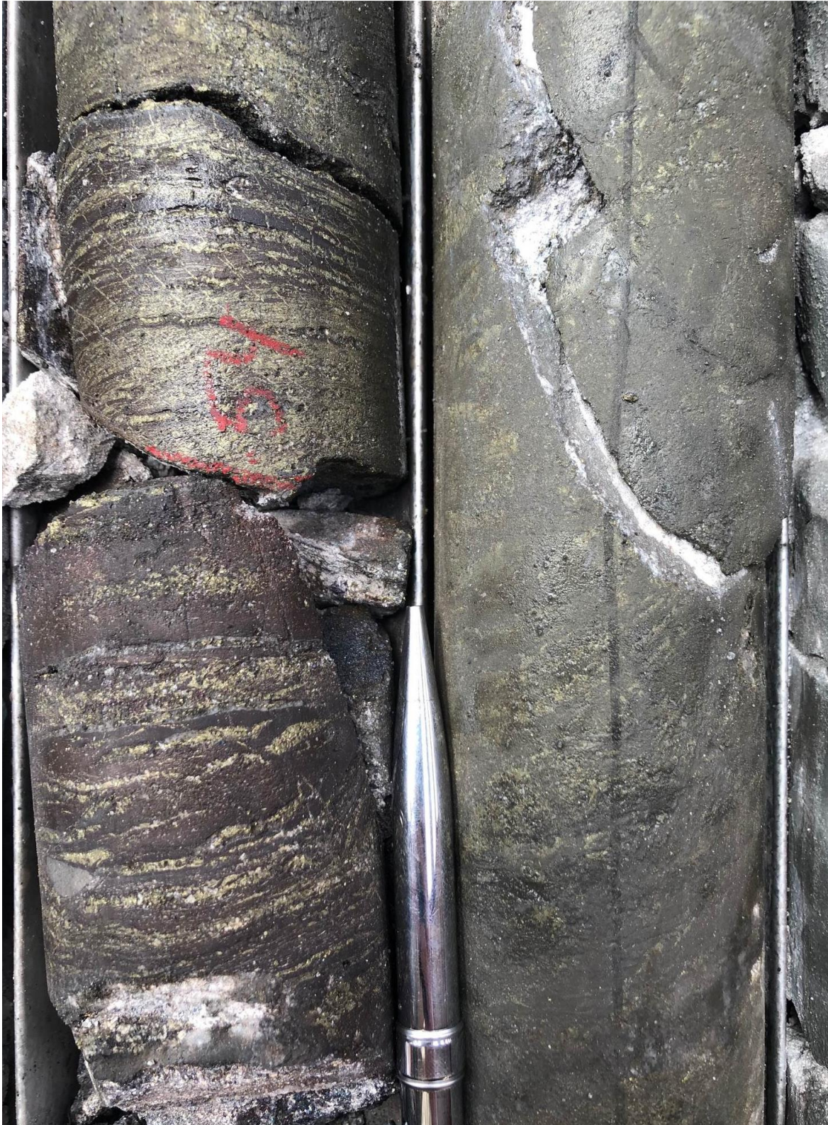
図4: 微量の黄銅鉱を含む巨大な斑銅鉱を示す坑井DD1571からの深度216メートルのコア。
