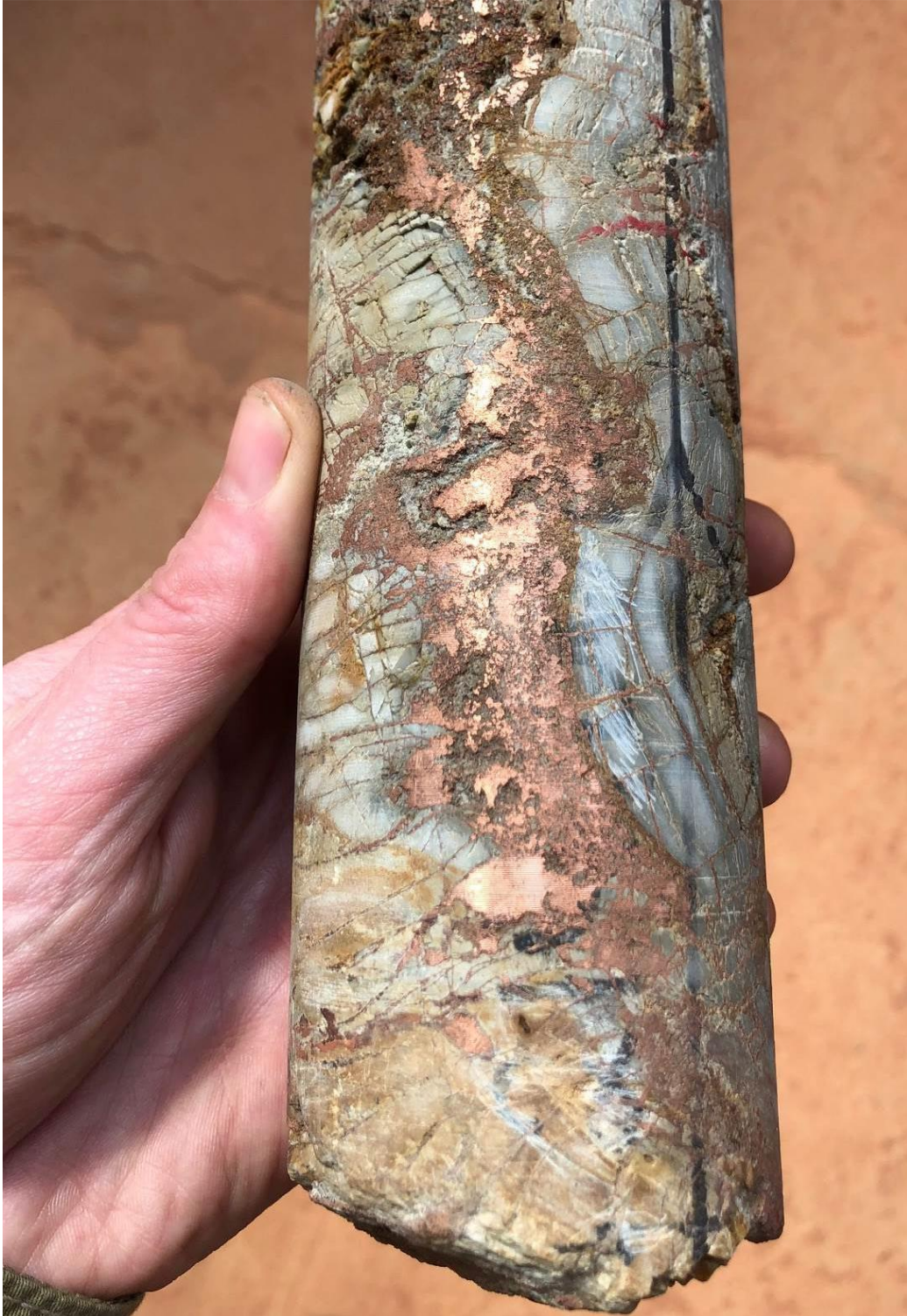
図5:角礫岩帯にある鉍染状の輝銅鉍と、それを貫く幅広な自然銅鉍脈を示す坑井DD1571からの深度214メートルのコア。
