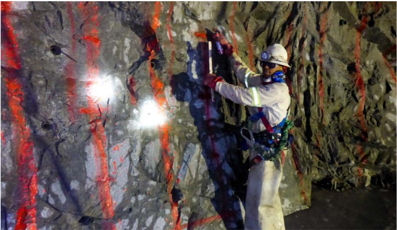
950 メートルのレベルのステーションで、次の爆破用ショットホールの掘削準備をしている削岩作業員。
