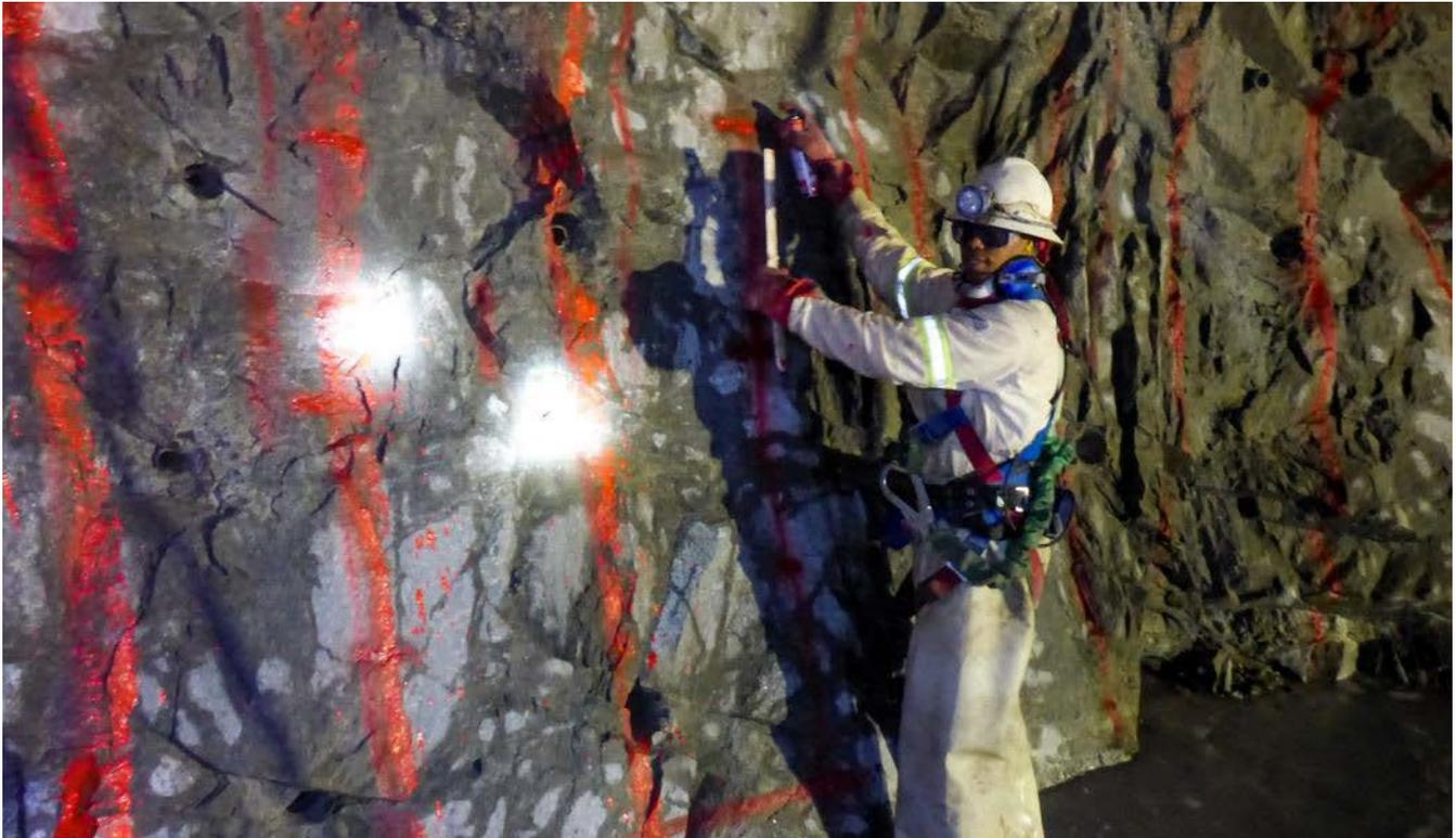
**Des foreurs de roches se préparent à forer des trous de forage pour le prochain dynamitage de développement à la station de 950 mètres.**
