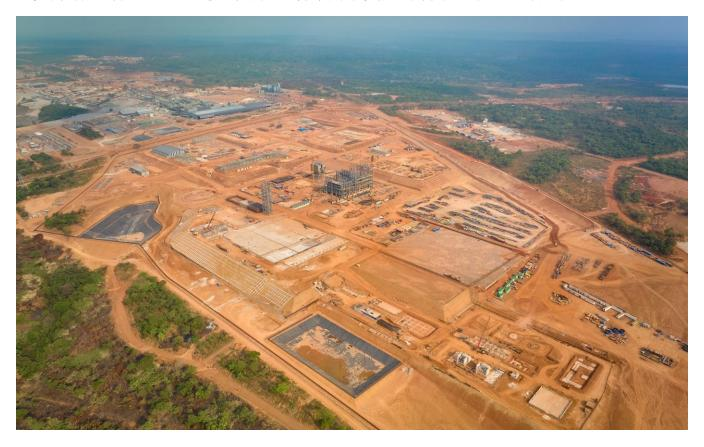
冶炼厂的精矿处理能力达 120 万吨/年,将处理 I 期和 II 期来自卡库拉和 III 期及后续 IV 期来自卡莫阿选厂的精矿。卡莫阿-卡库拉 2023 综合开发方案显示,冶炼厂将处理卡莫阿-卡库拉约 80%的精矿。根据与卢阿拉巴铜冶炼厂签订的为期十年的协议,卡莫阿铜业继续将部分精矿送往距离卡莫阿-卡库拉铜矿约 50 公里、靠近科卢韦齐镇的卢阿拉巴铜冶炼厂代加工,预计每年处理约 15 万吨铜精矿。
