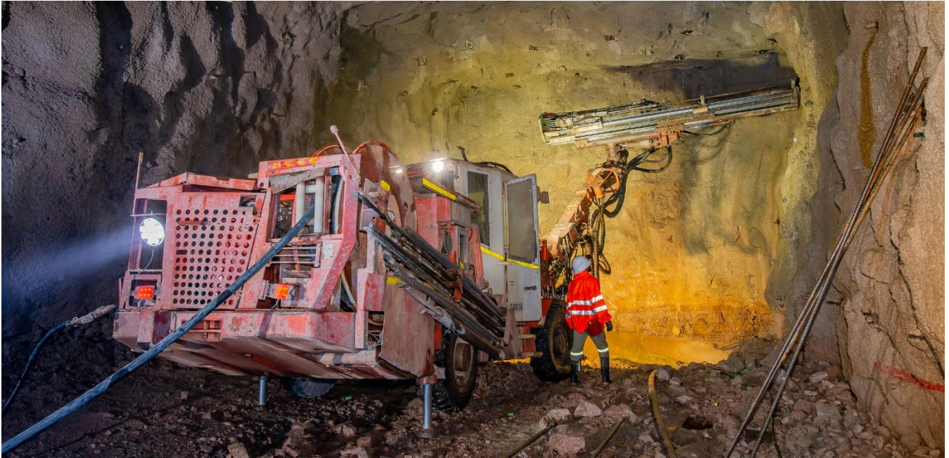
Figures 3 et 4 : Équipement minier de large capacité, semi-autonome en opération souterraine dans la mine de Kakula.
